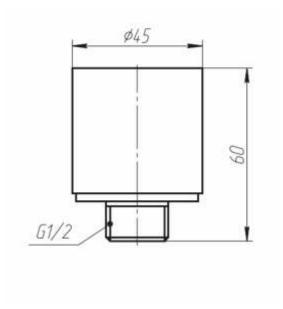
Рисунок 17 - Сигнализатор давления
