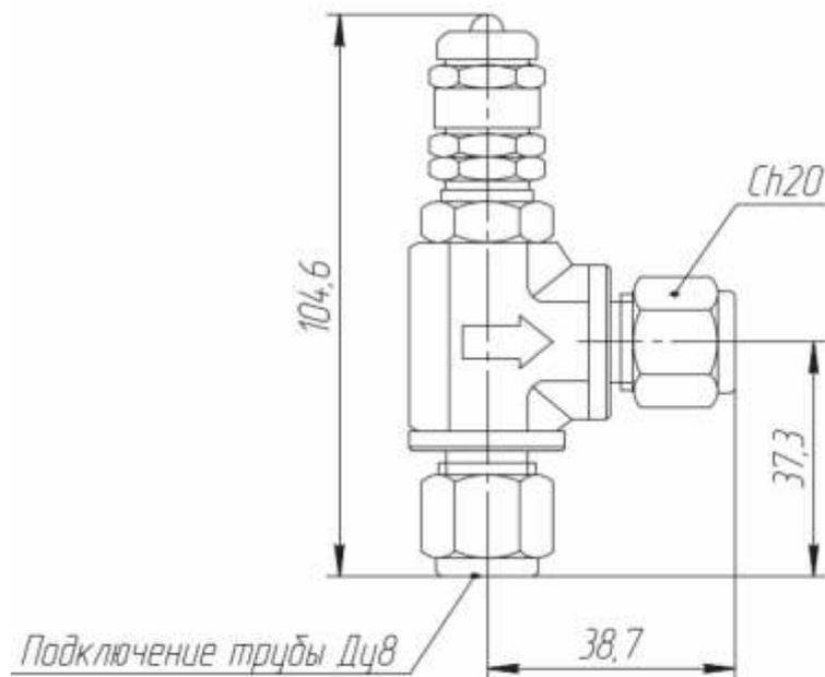
Рисунок 38 - Клапан предохранительный DN 8 мм
